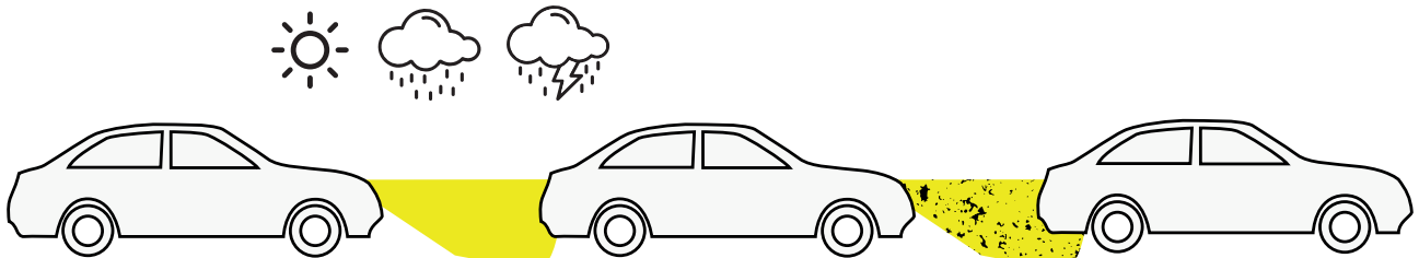
Abbildung 9: Kommunikation mittels sichtbaren Lichts kann durch viele externe Faktoren wie Wetter oder Schmutz beeinträchtigt werden. © Tobias Harges
