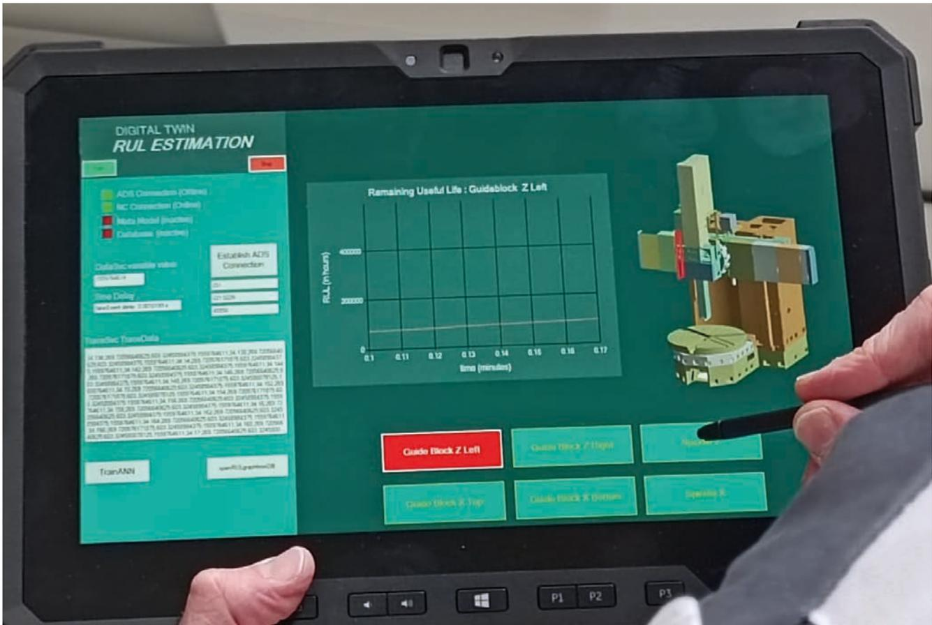
Abbildung 2: Digitaler Zwilling für die Restlebensdauer von CNC-Maschinen [© Fraunhofer IWU]
