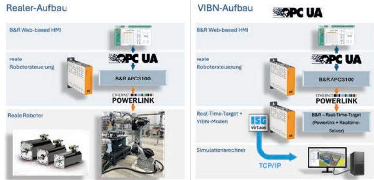
Abbildung 2: Vergleich der realen Steuerungsanbindung (links) und des HiL-Aufbaus (rechts) [© Fraunhofer IWU]
