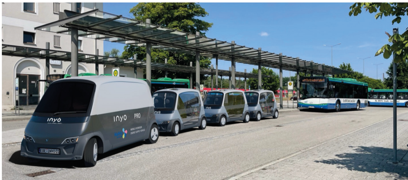
Abbildung 1: NeMo.bil-Konvoi bestehend aus einem NeMo.Pro und drei NeMo.Cabs [© INYO Mobility]
